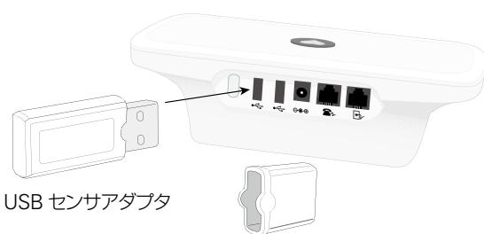
① USBセンサアダプタのキャップを外します。
