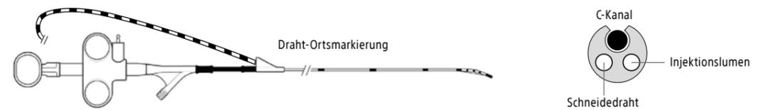
NEU Jagtome™ Revolution RX Sondierungspapillotom (Autotome™ mit vorgeladenem Jagwire Revolution Hochleistungsführungsdraht)
