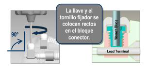
**Retire la llave.** Retire la llave dinamométrica tirando de ella directamente para sacarla del bloque conector.
