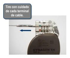
Evalúe las señales de los cables. Evalúe el rendimiento eléctrico de cada cable tras la conexión al generador de impulsos para realizar la confirmación final de que la conexión es adecuada. Asegúrese de que los canales auriculares y de VD/VI de referencia no presenten artefactos. Una conexión inadecuada podría dar lugar a que no se administre el tratamiento o que se administre uno inadecuado.
