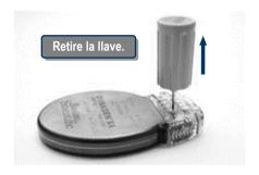
Compruebe que el cable esté bien fijado. Tire con cuidado del cable para comprobar que la conexión sea firme. Si el terminal del cable no está bien fijado, vuelva a insertar la llave dinamométrica como se ha descrito anteriormente y afloje el tornillo de fijación; para ello, gire la llave lentamente en sentido contrario al de las agujas del reloj hasta que se afloje el cable. A continuación, repita los pasos anteriores.
