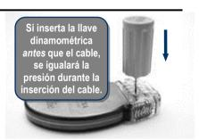
NOTA: Si no se inserta adecuadamente la llave dinamométrica en la hendidura del tapón de sellado, podrían dañarse el tapón y sus propiedades de sellado. No implante el generador de impulsos si los tapones de sellado tienen aspecto de estar dañados.
