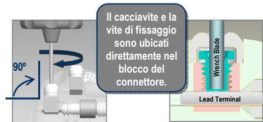
**Rimuovere il cacciavite.** Rimuovere il cacciavite dinamometrico tirandolo via direttamente dal blocco del connettore.
