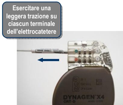
**Valutare i segnali degli elettrocatteteri.** Valutare la prestazione elettrica di ciascun elettrocattetero dopo il collegamento al generatore di impulsi, in modo da fornire la conferma definitiva del corretto collegamento. Accertarsi che i canali baseline atriale e VD/VS siano privi di artefatti. Un collegamento errato potrebbe provocare una perdita di terapia o l'erogazione di una terapia inappropriata.
